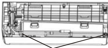
Porte di drenaggio
