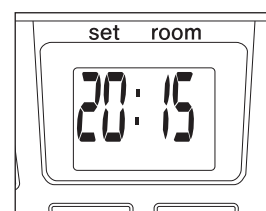
F: Når informationsdisplayet stopper med at blinke, er indstillingen låst til den indstillede værdi.
