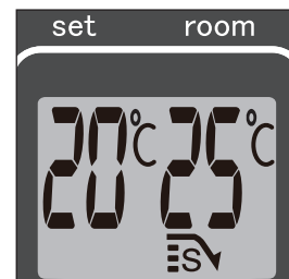
J: Cuando el piloto SAVE se ilumina, la estufa se encenderá y se apagará automáticamente, manteniendo la temperatura dentro de un determinado margen.
