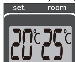
G: Önskad temperatur visas till vänster, och uppmätt temperatur visas till höger.
