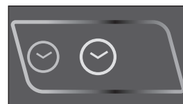
H: La lampe témoin TIMER indique que la fonction timer est active.
