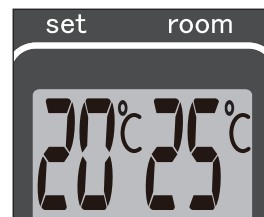
G: Vaadittu lämpötila vasemmalla, mitattu lämpötila oikealla.
