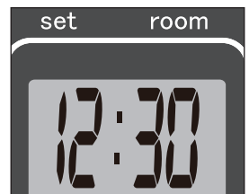
F: Wenn die 4-Stellige Zahl nicht mehr blinkt, sind die Einstellungen gespeichert.
