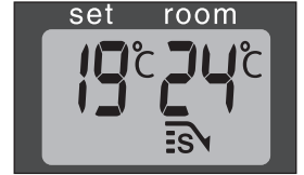
J: Kun SAVE-valo syttyy, lämmitin menee automaattisesti päälle tai kytkeytyy automaattisesti pois päältä niin, että lämpötila pysyy määritetyllä välillä.
