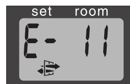
L: Når ventilasjonsindikatoren blinker, er det et tegn på at det er behov for ekstra ventilasjon.
