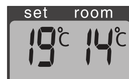
G: A sinistra la temperatura desiderata, a destra la temperatura misurata.
