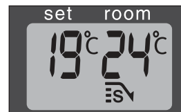
J: Når sparelampen tennes, slår varmeovnen seg på eller av automatisk for at temperaturen skal holde seg innenfor et bestemt område.
