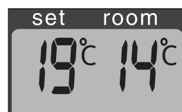
G: A gauche la température désirée, à droite la température mesurée.
