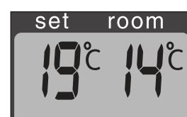
G: Ønsket temperatur til venstre, faktisk temperatur til høyre.
