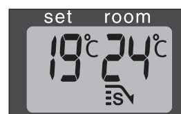
J: Når lampen SAVE lyser, slukkes eller tændes ovnen automatisk, sådan at temperaturen holder sig inden for et bestemt temperaturområde.
