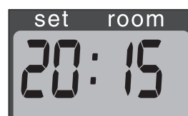
F: Når informationsdisplayet stopper med at blinke, er indstillingen låst til den indstillede værdi.
