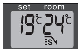
J: När SAVE-lampan tänds stängs värmaren av eller slås på automatiskt för att hålla sig inom ett specificerat temperaturintervall.
