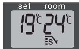
J: Kun SAVE-valo syttyy, lämmitin menee automaattisesti päälle tai kytkeytyy automaattisesti pois päältä niin, että lämpötila pysyy määritetyllä välillä.
