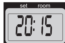
F: Quando os 4-dígitos deixarem de piscar, o acerto será bloqueado no valor indicado.
