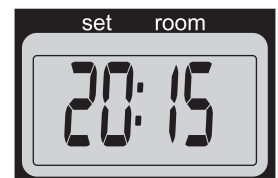
F: Wenn die 4-Stellige Zahl nicht mehr blinkt, sind die Einstellungen gespeichert.
