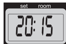
F: Quand les 4 chiffres arrêtent à clignoter, les valeurs insérées sont mémorisées.
